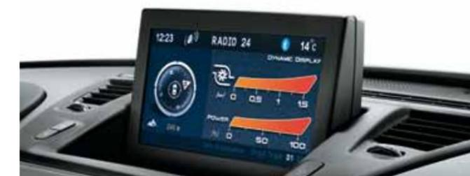
El Radio NAV muestra la presión del turbocompresor y la potencia suministrada en %.
