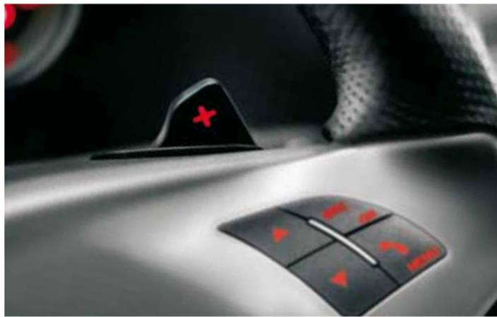
**CAMBIO ALFA TCT.** Un sistema de transmisión con doble embrague en seco, compuesto por dos cambios en paralelo que permiten engranar la siguiente marcha cuando aún está metida la anterior. Puede funcionar en modalidad totalmente automática o secuencial, mediante el mando TIP; de esta manera se gestionan manualmente los cambios de marcha con las posiciones up y down de la palanca de cambios o mediante los mandos en el volante.
