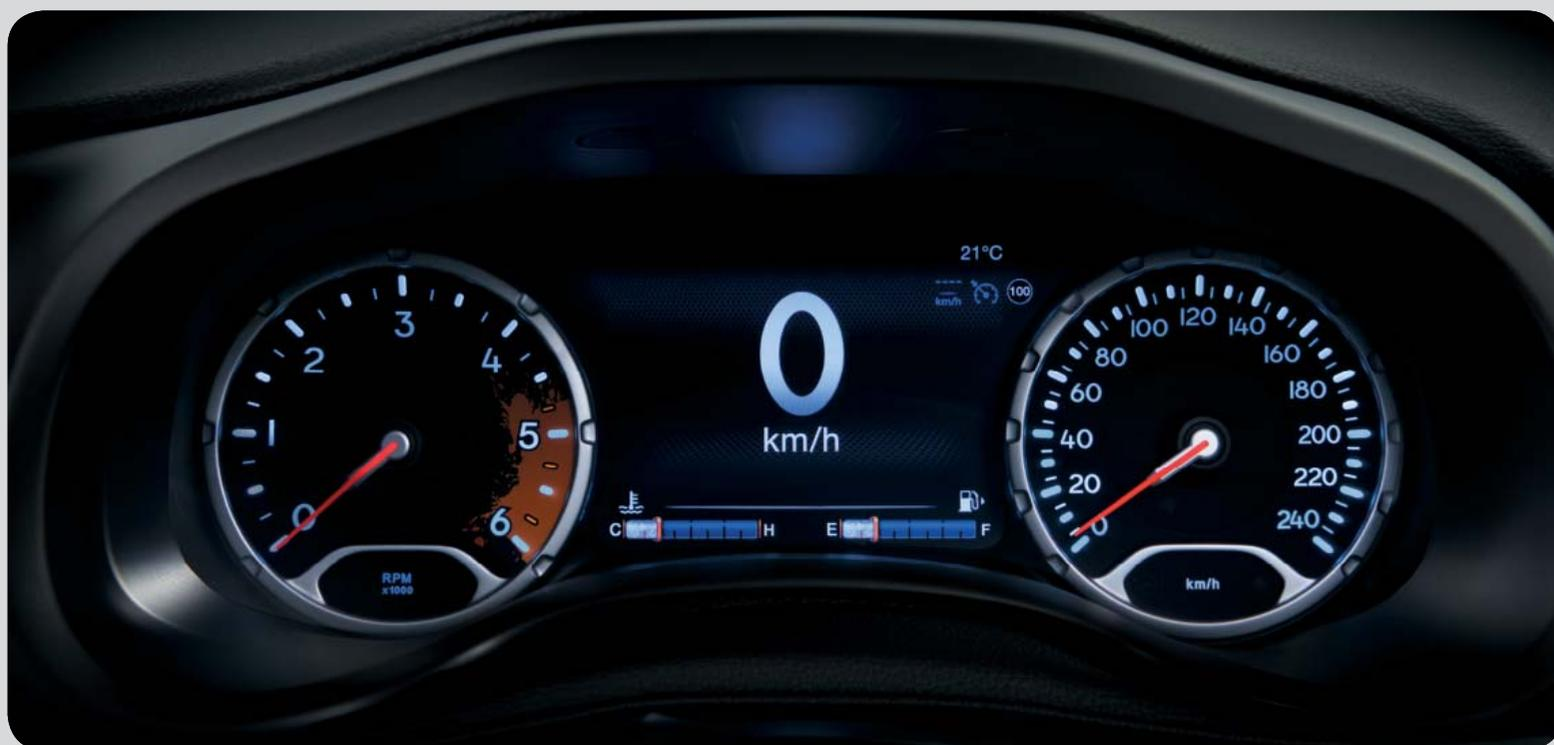
El conductor puede elegir entre una gran cantidad de información que puede visualizarse en el centro del cuadro de instrumentos y que incluye las indicaciones paso a paso del navegador, la velocidad, el consumo de combustible en tiempo real, las advertencias de seguridad (incluido el Sistema de Asistencia al Aparcamiento en línea/batería y el Aviso de Salida de Carril Plus), la información de audio y las características específicas de Jeep®, incluyendo el sistema Selec-Terrain.
